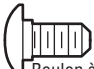
Boulon à tête bombée et collet carré de 1/4 de po-20 x 1/2 po (2)
