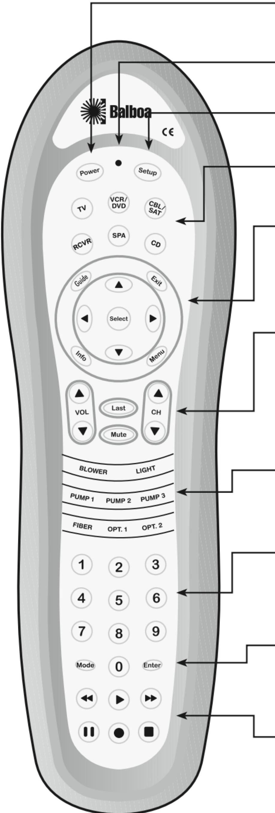
Durch einmaliges Drücken der Taste POWER wird die gewählte Heim-Entertainment-Komponente ein- oder ausgeschaltet.
