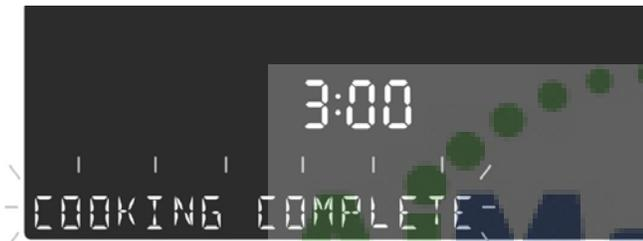
Cet écran reste dans l'affichage jusqu'à ce qu'on l'efface en appuyant sur la touche à effleurement « **Four Effacer/Désactiver** » ou jusqu'à ce que la sonde soit retirée. Ensuite, l'écran repasse en mode Veille.
