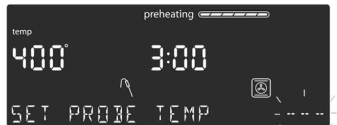
5. La température actuelle de la sonde et la température cible sont affichées au format « 105/180 » dans le coin inférieur droit de l'écran. La température réelle
