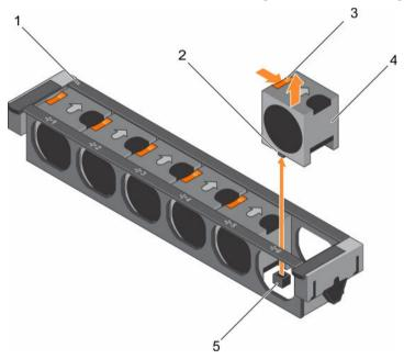
Figure 14. Removing a cooling fan
