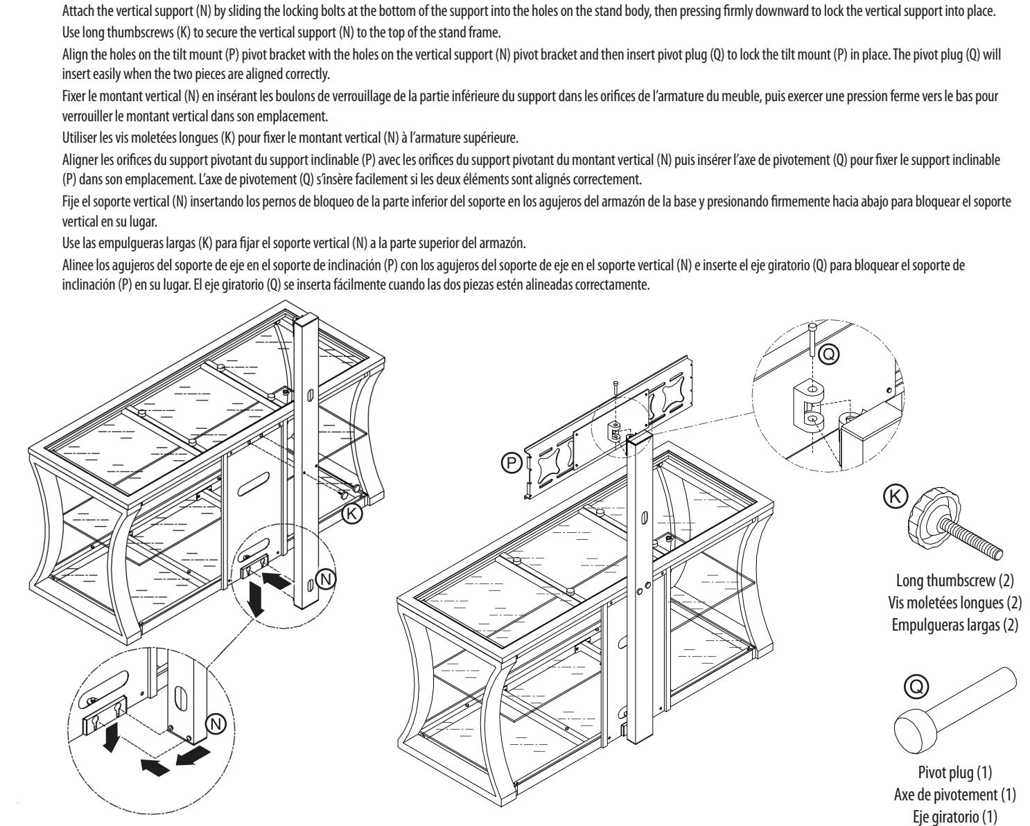
**7** **Installing the TV Mount Brackets / Installation des supports de montage pour le téléviseur / Instalación de los soportes de montaje del televisor**
