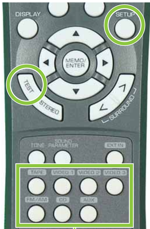
Input buttons (remote control) Touches d'entrée (télécommande) Botones de entrada (control remoto)
