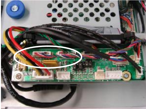
c. Disconnect the cables (3): COM3 cable (CN4), COM4 cable (CN5), and LPT cables (CN7).
