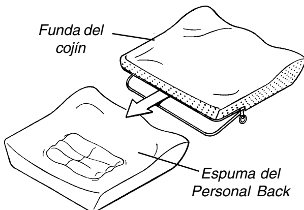
FIGURA 1 - RETIRAR LA ESPUMA DEL PERSONAL BACK DE LA FUNDA
