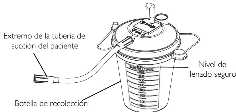
FIGURA 2 Componentes de la botella de recolección
