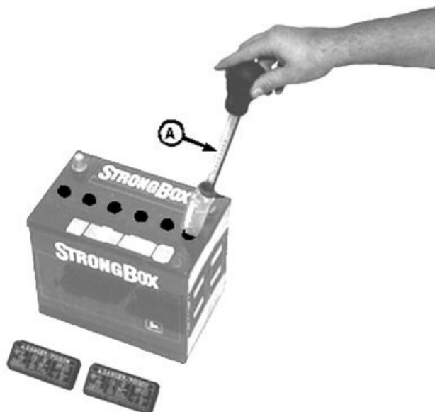
Vérification de l'état de charge
