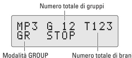
È possibile cambiare la modalità di riproduzione MP3/WMA premendo MP3/WMA PLAY MODE.
