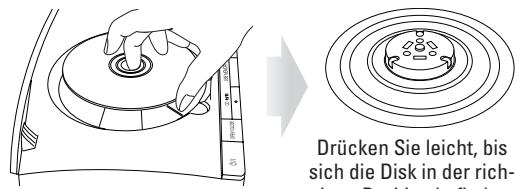
Drücken Sie leicht, bis sich die Disk in der richtigen Position befindet.
