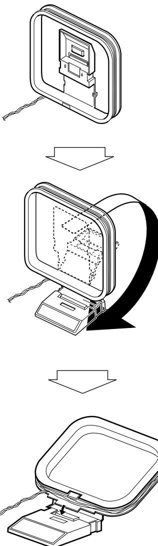
**Pour raccorder l'antenne AM à cadre**
