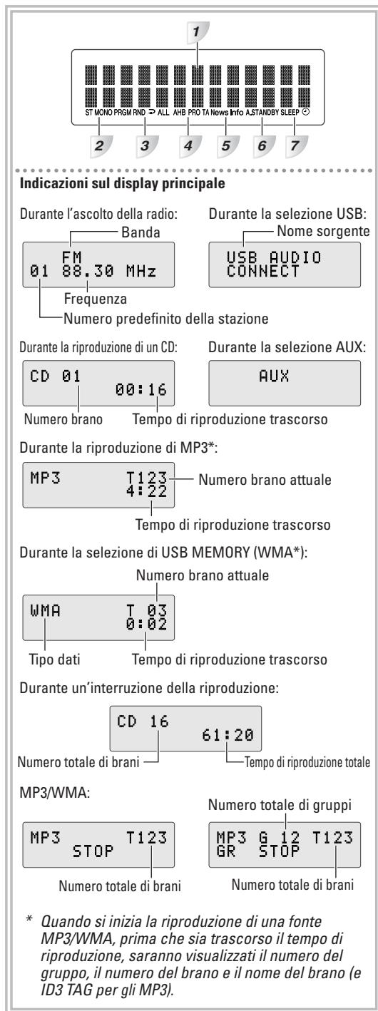
\* Quando si inizia la riproduzione di una fonte MP3/WMA, prima che sia trascorso il tempo di riproduzione, saranno visualizzati il numero del gruppo, il numero del brano e il nome del brano (ID3 TAG per gli MP3).
