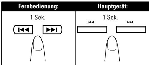
Die Frequenzanzeige im Display ändert sich. Wenn auf einen Sender (eine Frequenz) mit ausreichender Signalstärke abgestimmt ist, bleibt der Frequenzlauf stehen.
