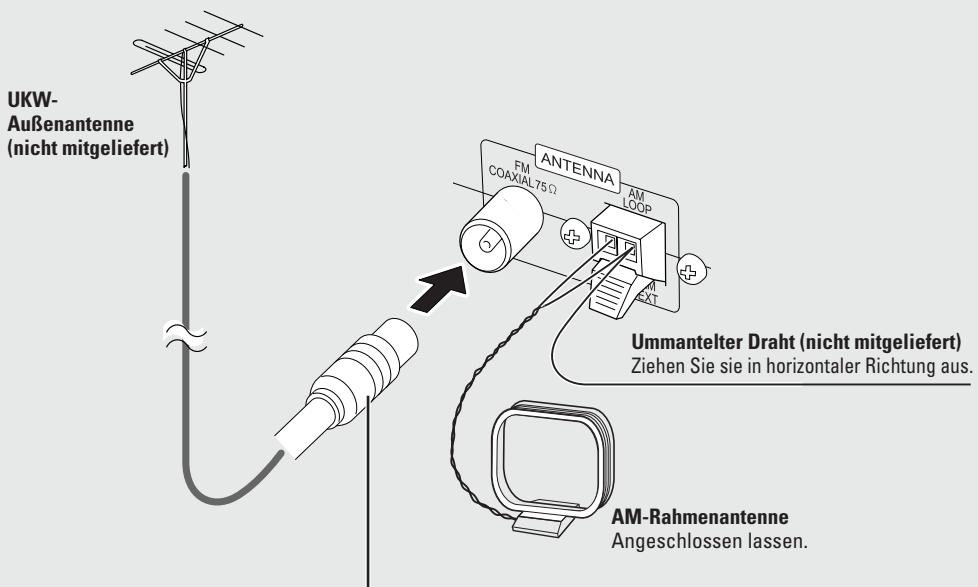
Trennen Sie die mitgelieferte UKW-Antenne ab, und schließen Sie eine UKW-Außenantenne mit einem  $75\Omega$ -Draht mit Koaxstecker an.
