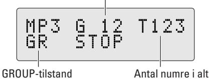
Du kan ændre MP3/WMA-afspilningstilstanden ved at trykke på MP3/WMA PLAY MODE.
