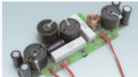
ACE-Technologie für besseren Bass (oben) Frequenzweiche (unten)
