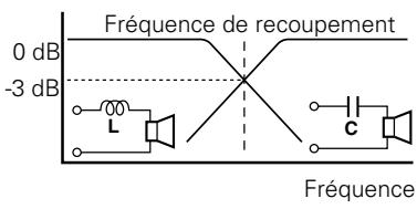
**Self (L) :** Elle laisse passer les fréquences graves mais bloque les fréquences aiguës (filtre passe-bas).
