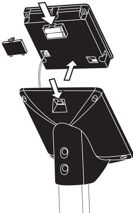
Eine schwache oder erloschene Computeranzeige macht einen Batteriewchsel erforderlich. Der Computer ist mit zwei Batterien ausgestattet. Nehmen Sie den Batteriewchsel wie folgt vor:
