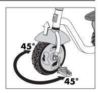
Rear steering system locked/unlocked Direction arrière bloquée/libre
