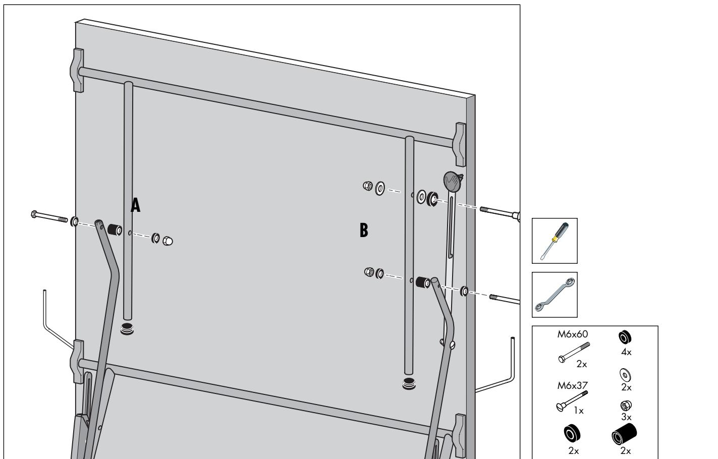
**D** A: Verschrauben Sie die linke Schubstrebe mit dem Tragrahmen.
