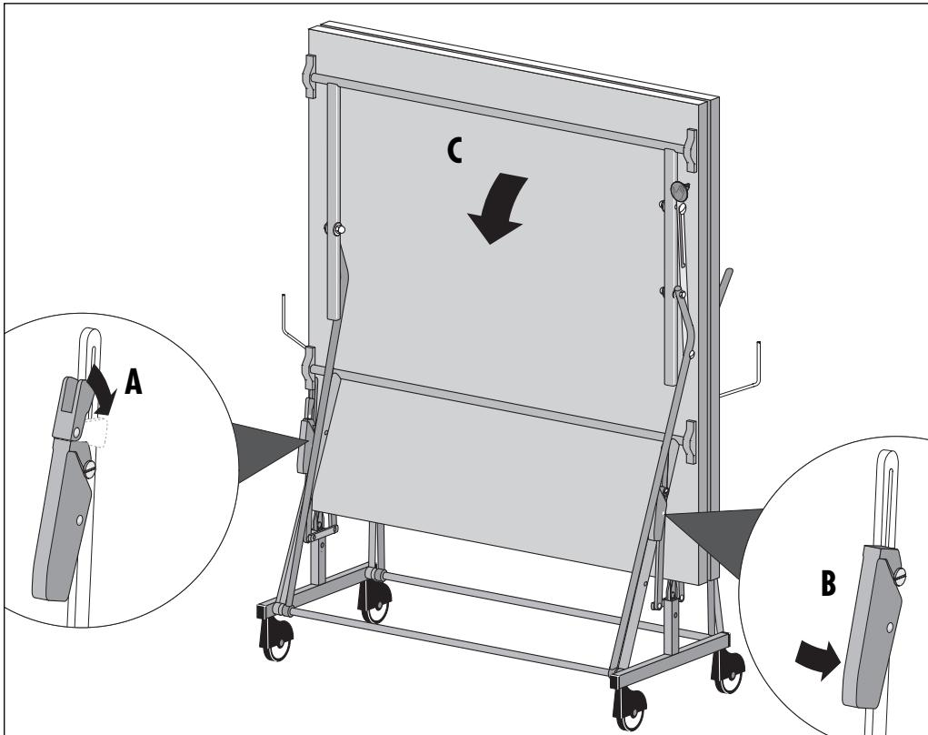
**D** Drücken Sie die linke Kippsicherung und legen Sie den Feststellknobel um. Anschließend die Platte mit einer Hand festhalten, rechte Kippsicherung drücken und Platte langsam herunterklappen (Platte unter keinen Umständen einfach fallen lassen!).
