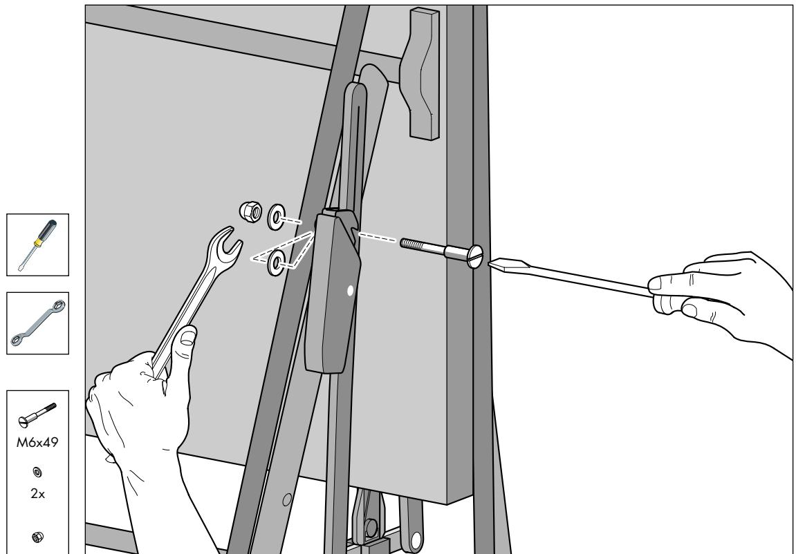
**D** Verschrauben Sie die Kippsicherung mit Feststeller auf der linken Plattenseite. Rechts wird ebenso verfahren. Lösen Sie nun das vormontierte Verbindungsrohr auf der anderen Seite und führen Sie die Schritte 4 bis 8 für die zweite Plattenhälfte durch. Denken Sie auch hier wieder an die Sicherung der Platte!
