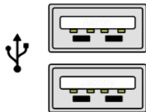
Figura 1.1 - Porte USB 2.0 - Tipo A
