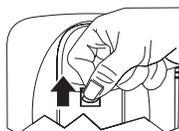
2. Faites pivoter le crochet de rétention de façon à ce que la languette soit vers le haut.
