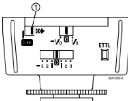
La sincronizzazione sulla seconda tendina (REAR) viene attivata sullo SCA 3102 tramite il selettore ① per il funzionamento REAR. Tale selettore deve essere portato nella posizione di destra (v. figura sotto). L'impostazione sullo SCA 3102 ha la priorità sull'impostazione del tipo di sincronizzazione della fotocamera!
