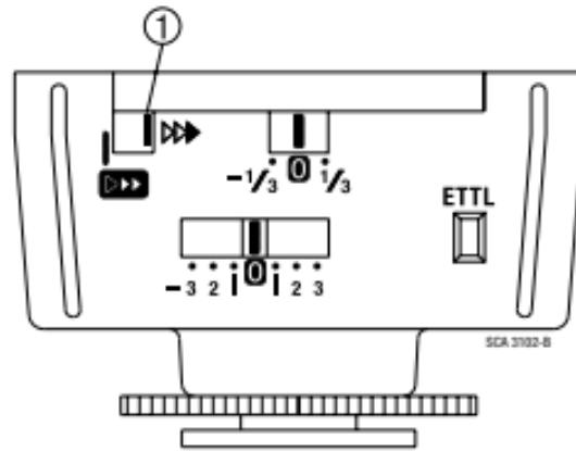
La sincronización a la 2<sup>a</sup> cortinilla (REAR) se activa en el SCA 3102 con el interruptor ① para el funcionamiento REAR. Mover este interruptor a la posición derecha (vea grabado). El ajuste en el SCA 3102 prevalece sobre el ajuste de sincronización en la cámara!
