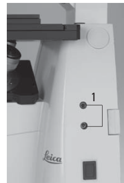
Abb. 92 Justierung der Feldblende (Auflicht-Fluoreszenz) 1 Justierschrauben für Verschiebung der Feldblende
