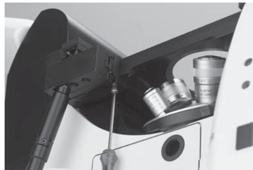
Abb. 24 Montage des Objektführers
