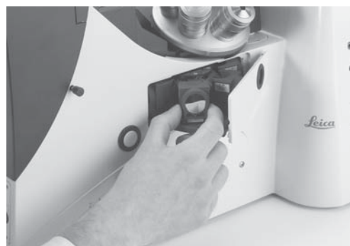
Abb. 68 Einsetzen oder Entnehmen eines Filterwürfels
