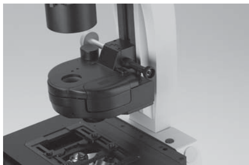
Abb. 41 Am DL-Beleuchtungsarm montierter Kondensor
