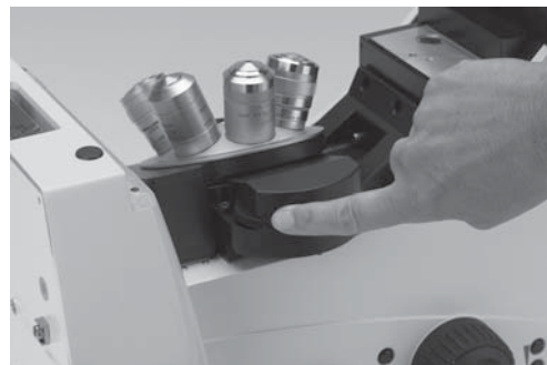
Abb. 111 DIC-Scheibe mit Rändelrad zur Feinjustierung
