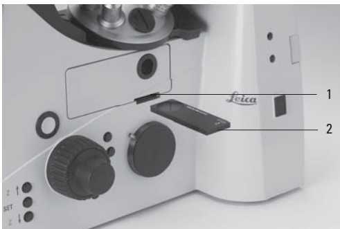
Abb. 73 Montage des Analysators 1 Aufnahme 2 Analysator
