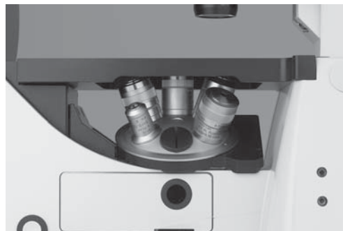
Abb. 45b Objektivrevolver, bestückt
