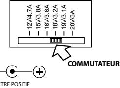
Utilisez l'illustration ci-dessus pour vérifier si l'ordinateur utilise une polarité centrale positive; la plupart des ordinateurs portables utilisent une polarité centrale positive. N'utilisez pas le bloc d'alimentation LAC90 si l'ordinateur utilise une polarité centrale négative.
