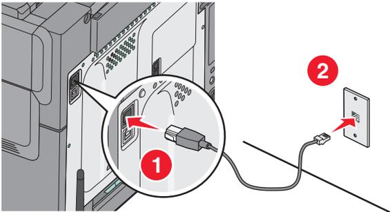
Sluit de netwerkkabel aan op de printer en vervolgens op het stopcontact.
