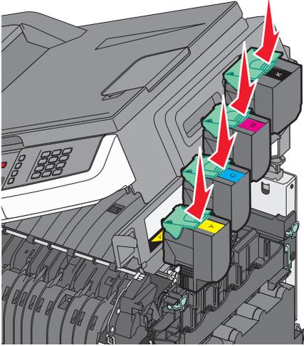
Lijn de cartridges uit en plaats deze. Duw ze dan naar beneden om ze vast te zetten.
