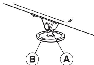
**Nota:** es muy importante que la barra estabilizadora esté bien ajustada para lograr el funcionamiento adecuado. Una unidad desequilibrada puede causar la pérdida de alineación de la banda para caminar. Se recomienda utilizar un nivel de burbuja para asegurar la correcta alineación.
