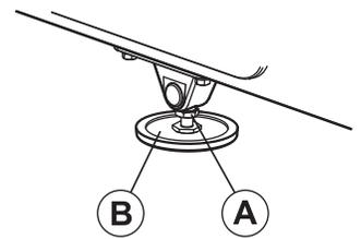
**Nota:** es muy importante que la barra estabilizadora esté bien ajustada para lograr el funcionamiento adecuado. Una unidad desequilibrada puede causar la pérdida de alineación de la banda para caminar. Se recomienda utilizar un nivel de burbuja para asegurar la correcta alineación.
