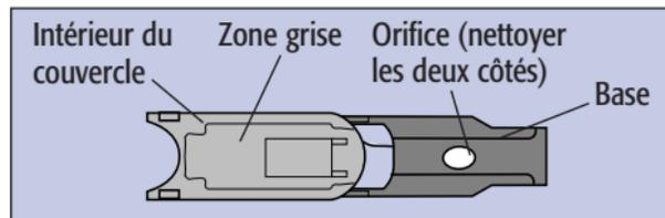
3. Utilisez un coton-tige ou un chiffon doux avec de l'eau et nettoyez la zone de la lentille et les points de contact. Ne pas rayer la lentille. **Séchez avec un chiffon doux ou un papier mouchoir qui ne laisse pas de charpies et qui ne contient ni lotion, ni parfum. N'utilisez pas de matériaux abrasifs telles les serviettes en papier.**
