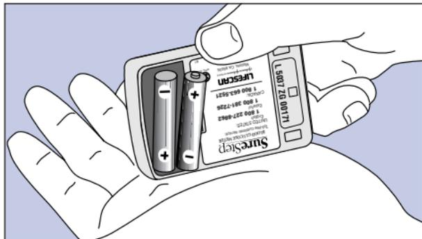
4. Insérez deux nouvelles piles alcalines AAA, en faisant correspondre le pôle + des piles avec le signe + inscrit dans le logement des piles.
