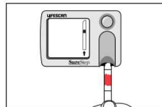
**4** Insérez à fond la bandelette de test, le bout effilé en premier, avec le point de confirmation vers le bas dans le support de bandelette jusqu'à ce qu'elle se bloque. Faites la lecture du résultat. Ne retirez pas la bandelette avant la fin du compte à rebours.
