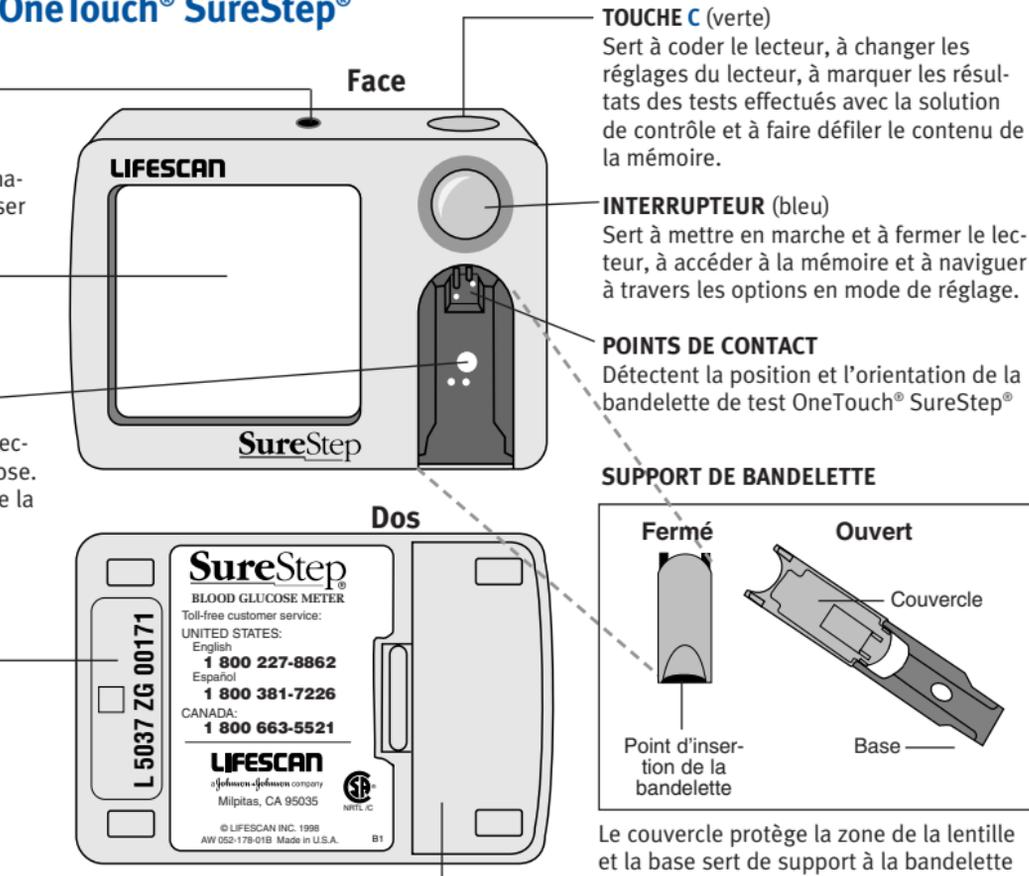
Le couvercle protège la zone de la lentille et la base sert de support à la bandelette de test OneTouch® SureStep®
