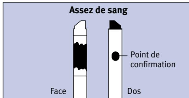
Si des taches ou des lignes blanches apparaissent sur le point de confirmation bleu, vous n'avez pas appliqué suffisamment de sang pour un test exact. Vous devez recommencer avec une nouvelle bandelette de test.
