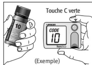
**4** Comparez le numéro de code à l'écran du lecteur avec le numéro de code sur le flacon de bandelettes de test. Si les deux numéros de codes ne sont pas identiques, appuyez sur la touche **C** verte jusqu'à ce que le numéro de code à l'écran corresponde au numéro de code du flacon de bandelettes de test.
