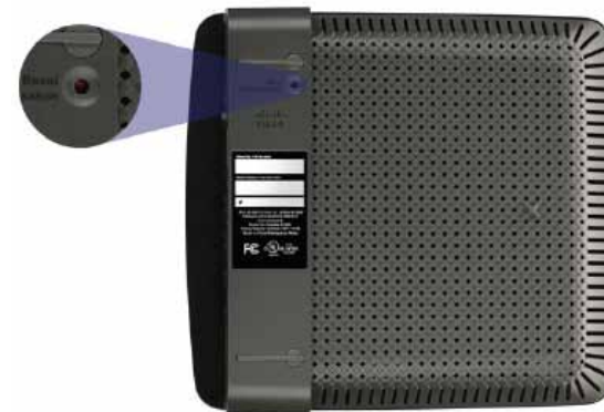
Bouton Reset des modèles EA2700 et EA3500
