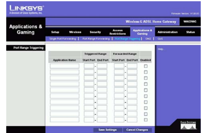
Figur 5-29: Port Triggering (Aktivering af porte)
