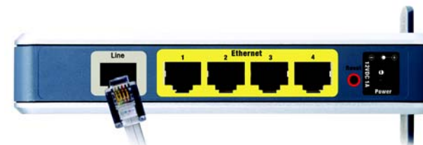
Figure 4-1 : Connexion d'une ligne ADSL
