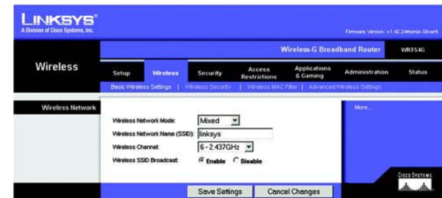
Figura 5-17: Separador Wireless (Sem fios) - Basic Wireless Settings (Definições sem fios básicas)
