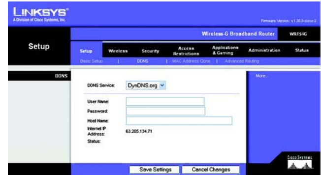
Figura 5-13: Scheda Setup (Configurazione) - DDNS
