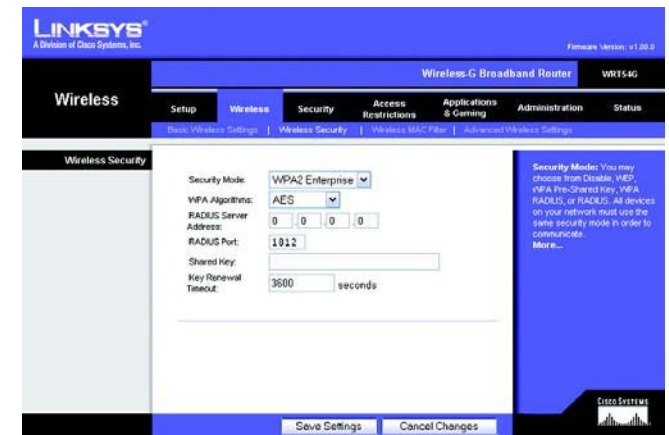
Figur 5-21: Fliken Wireless (Trådlöst) – Wireless Security (Trådlös säkerhet) (WPA2 Enterprise)
