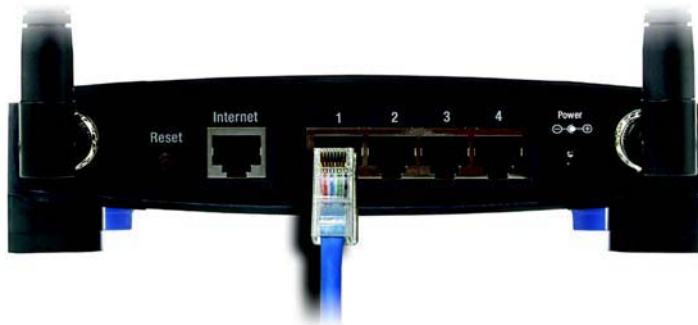
Figura 4-2: Conexión de los dispositivos de red
