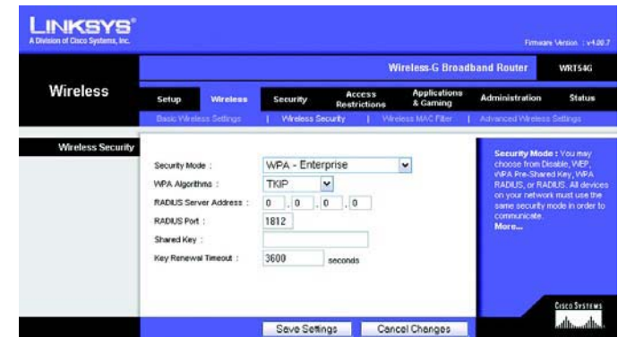
Figura 5-19: Separador Wireless (Sem fios) - Wireless Security (WPA Enterprise) (Segurança sem fios (WPA Enterprise))
