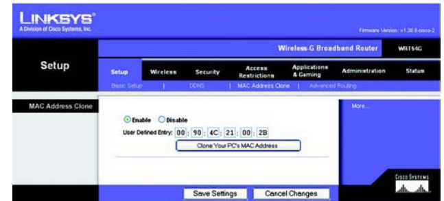
Figure 5-14 : Onglet Setup - MAC Address Clone (Configuration - Adresse MAC dupliquée)
