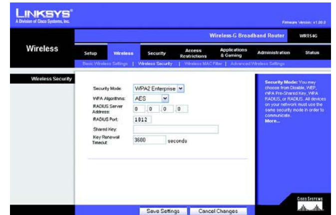
Figura 5-21: Separador Wireless (Sem fios) - Wireless Security (WPA2 Enterprise) (Segurança sem fios (WPA2 Enterprise))
