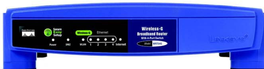
Figuur 3-2: Het voorpaneel van de router
