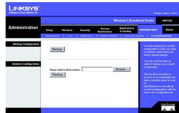
Figura 5-45: Scheda Administration (Amministrazione) - Config Management (Gestione configurazione)
