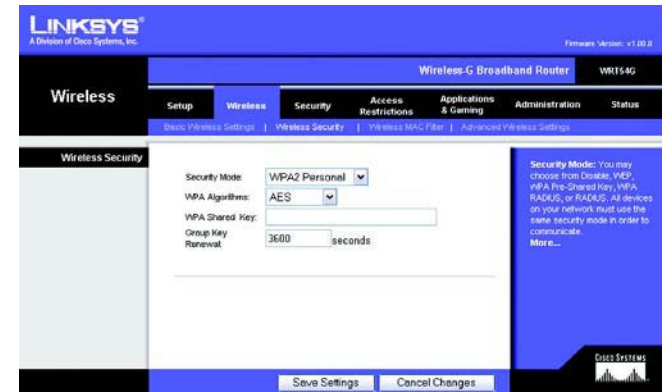
Figura 5-20: Ficha Wireless (Inalámbrico) - Wireless Security (WPA2 Personal) (Seguridad inalámbrica, WPA2 Personal)
