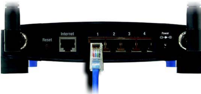
Figura 4-6: Collegamento dei dispositivi di rete
