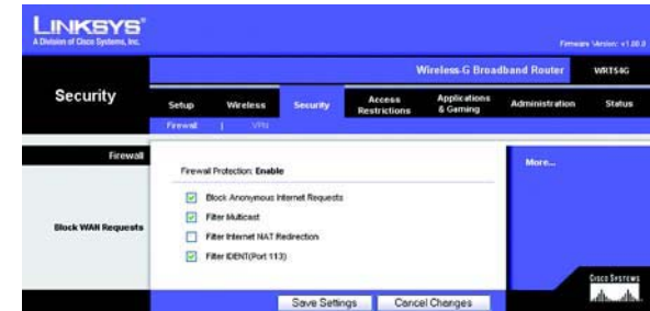
Figuur 5-27: Tabblad Security (Beveiliging) - Firewall
