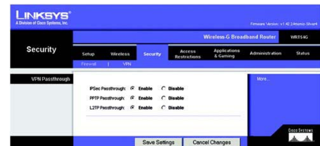
Figura 5-28: Separador Security (Segurança) - VPN Passthrough (Passagem VPN)
