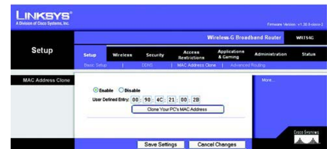
Figur 5-14: Fanen Setup - MAC Address Clone (Konfiguration - Kopi af MAC-adresse)
