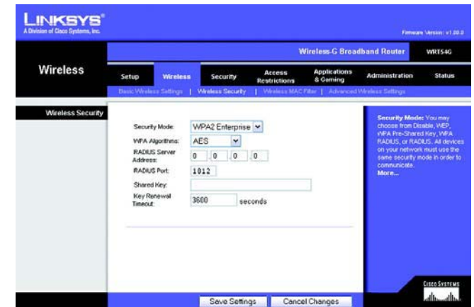
Figur 5-21: Fanen Wireless - Wireless Security (WPA2 Enterprise) (Trådløs - Trådløs sikkerhed (WPA2 Enterprise))
