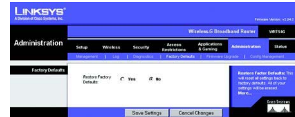
Figura 5-43: Separador Administration (Administração) - Factory Defaults (Predefinições de fábrica)
