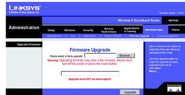
Abbildung 5-44: Registerkarte „Administration“ (Verwaltung) – „Firmware Upgrade“ (Aktualisieren der Firmware)
