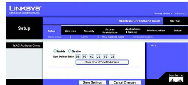
Figura 5-14: Scheda Setup (Configurazione) - MAC Address Clone (Clonazione indirizzo MAC)
