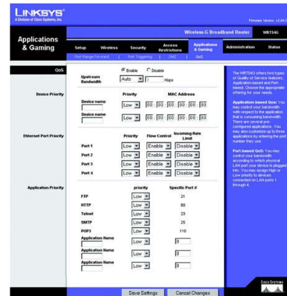
Abbildung 5-37: Registerkarte „Applications & Gaming“ (Anwendungen & Spiele) – „QoS“
