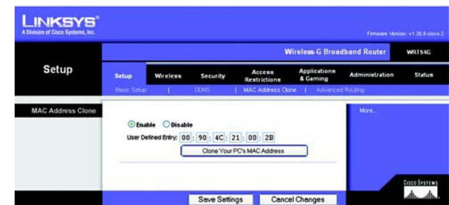
Figura 5-14: Ficha Setup (Configuración) - MAC Address Clone (Clonación de direcciones MAC)
