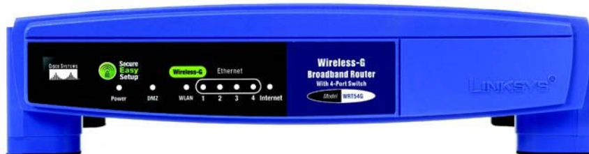
Figure 3-2 : Panneau avant du routeur
