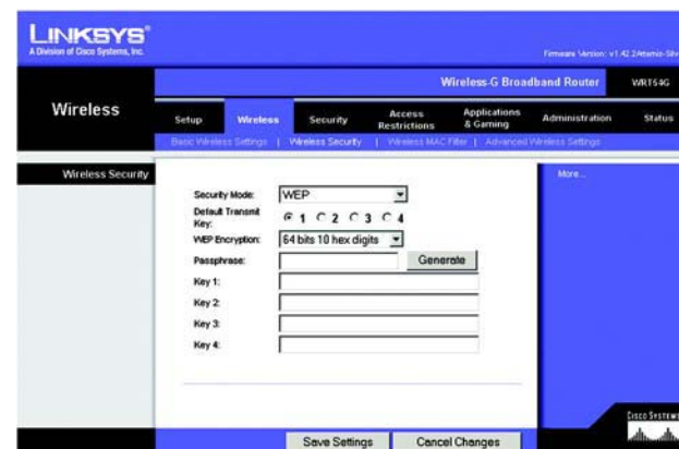
Figura 5-23: Separador Wireless (Sem fios) - Wireless Security (WEP) (Segurança sem fios (WEP))
