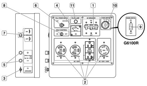
(d) Turn the no-fuse breaker to the position "ON"
