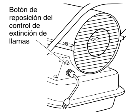
Figura 6 - Botón de reposición del control de extinción de llamas, modelo de 29,3/44 kW (100.000/150.000 Btu/hr)
