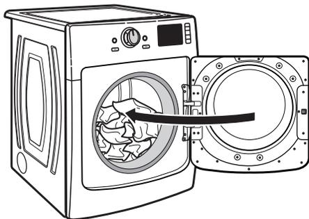
Ouvrir la porte en tirant sur la poignée. Placer le linge dans la sècheuse. Ajouter une feuille de réduction de l'électricité statique pour tissu à la charge mouillée si désiré. Fermer la porte.
