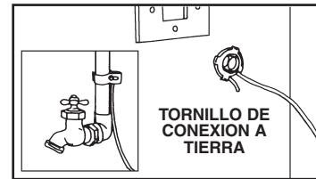
**NUNCA CONECTE EL ALAMBRE DE TIERRA A TUBERÍAS DE PLOMERÍA DE PLÁSTICO, TUBERÍAS DE GAS NI A TUBERÍAS DE AGUA CALIENTE.**
