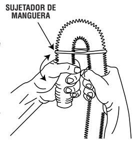
Asegúrese de **NO** hacer una conexión hermética entre la manguera de desagüe y el tubo vertical. Se recomienda un tubo vertical de 36" (91,44 cm) de alto. El tubo vertical también debe ser de un diámetro interior mínimo de 1 1/8" (2,86 cm).
