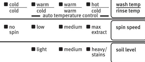
Après avoir sélectionné un programme, les réglages par défaut correspondant à ce programme s'allument. Appuyer sur les boutons de modificateurs du programme pour modifier le niveau de saleté, la vitesse d'essorage et la température de lavage/rinçage si désiré. Tous les réglages ne sont pas disponibles avec tous les programmes.
