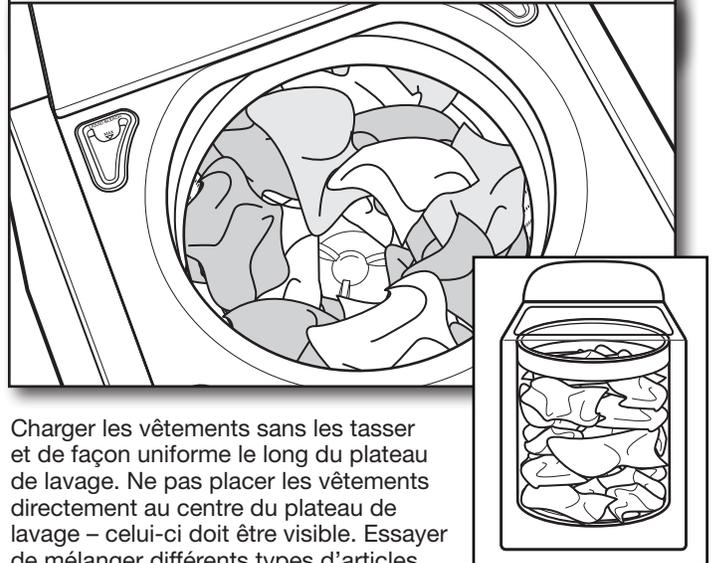
Charger les vêtements sans les tasser et de façon uniforme le long du plateau de lavage. Ne pas placer les vêtements directement au centre du plateau de lavage – celui-ci doit être visible. Essayer de mélanger différents types d'articles pour réduire l'emmêlement.
