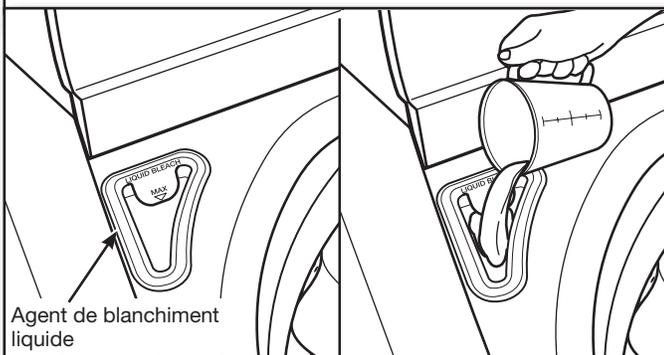
Ne pas remplir excessivement le distributeur, diluer le produit ou utiliser plus de 3/4 de tasse (180 mL). Ne pas utiliser d'agent de blanchiment sans danger pour les couleurs ni de produit Oxi en même temps que le programme utilisant de l'agent de blanchiment liquide.
