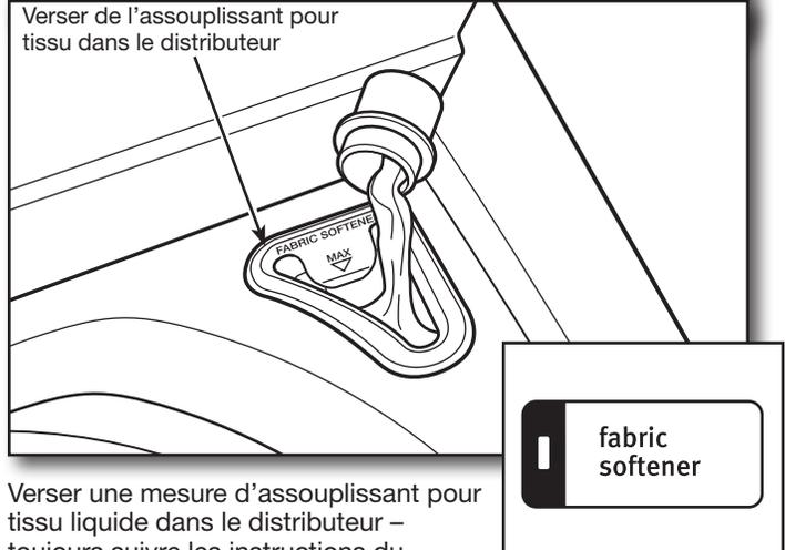
Verser une mesure d'assouplissant pour tissu liquide dans le distributeur – toujours suivre les instructions du fabricant concernant la dose d'assouplissant pour tissu à utiliser en fonction de la taille de la charge. Sélectionner ensuite l'option Fabric Softener (Assouplissant pour tissu).
