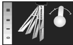
Sie können mit dem Pendelhubschalter **12** die Pendelbewegung des Sägeblattes **14** einstellen. Ohne Pendelbewegung (Stellung „0“) erzielen Sie feine und saubere Schnittkanten. Stellen Sie bei dünnen Werkstücken den Pendelhub ab. Mit aktiviertem Pendelhub (Stellung 1 - 3) erzielen Sie einen zunehmend schnelleren Arbeitsfortschritt.
