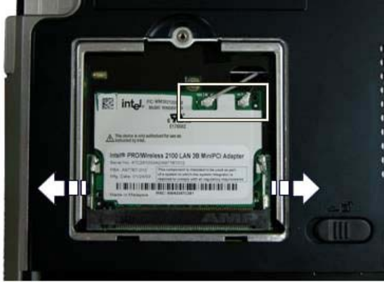
Fig. 5 Removing the mini PCI card
