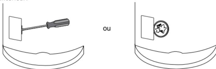
2. Remplacez la pile SR44 par une nouvelle pile SR44, le signe + vers le dessus.
