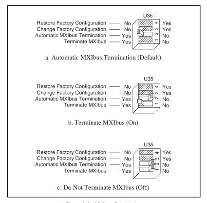
Figure 3-9. MXIbus Termination
