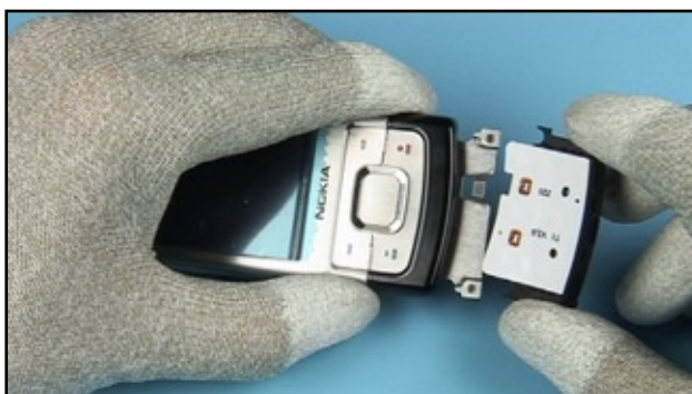
29. Remove the BOTTOM FLEX.
