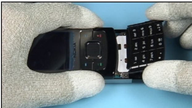
57. Insert the BOTTOM KEYMAT.
