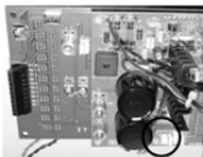
Connexion de la fiche du carillon
