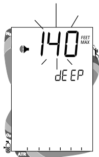
Fig. 21 - Set MaxDepth Alarm
