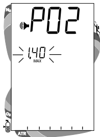
Fig. 37 - Maximum PO2 Alarm
