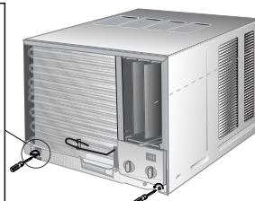
Chassis locking bracket Soportes que cierran el chasis
