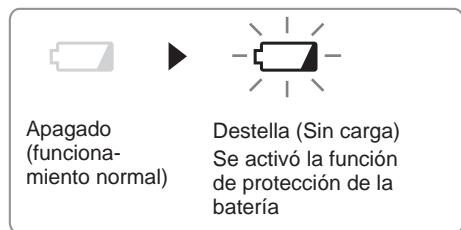
Una descarga excesiva (completa) de las baterías de Li-ion acorta dramáticamente su vida de servicio. El destornillador contiene una función de protección de batería diseñada para evitar una descarga excesiva de la batería.
