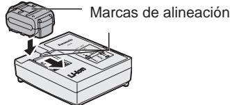
3. La luz indicadora de carga permanecerá encendida durante la carga. Cuando haya terminado la carga, se accionará automáticamente un conmutador electrónico interno para impedir cualquier sobrecarga.
