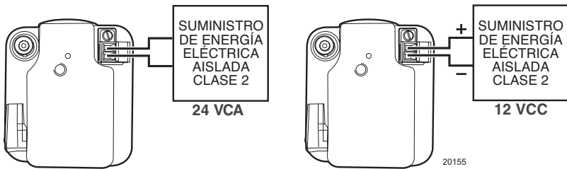
Figura 4. Conexiones de suministro de energía
