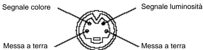
Ingresso S-VIDEO (Mini DIN a 4-pin)
