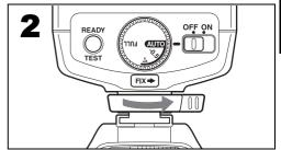
●ペンタックスデジタル一眼レフカメラは、シューロックピンに対応しています。取り付けるときは、締め付けノブを「FIX→」方向に回して、シューロックピンでストロボを固定してください。取り外すときは、必ず締め付けノブを「FIX→」と反対の方向に回して、ノブを緩めてから取り外してください。固定したままの取り外しは、ホットシューが傷つく原因となります。
