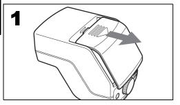
図のように電池ぶたをスライドしてから、電池ぶたを外します。
