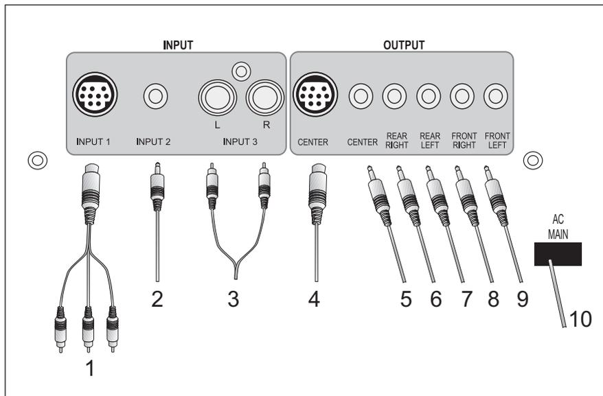
Подключение к звуковой плате с выходом 5.1-канального объемного звука (или проигрывателю DVD со встроенным 5.1-канальным декодером - кабель в комплект не входит):
