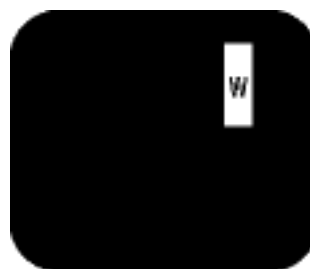
Trois sous-pixels adjacents allumés (un pixel blanc)
