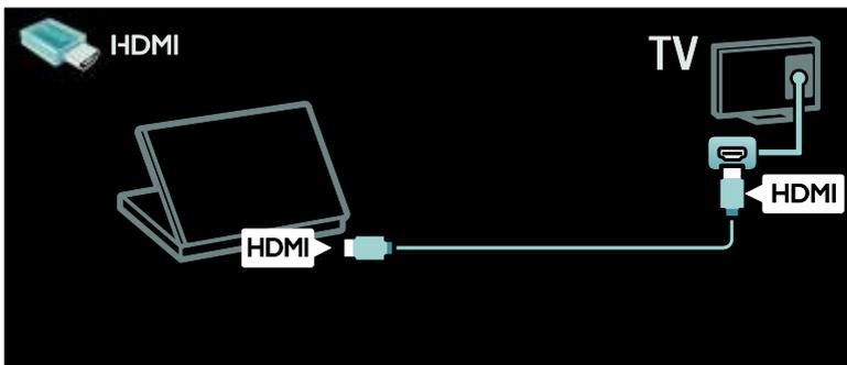
Schließen Sie den Computer über ein DVI-HDMI-Kabel am Fernsehgerät an.
