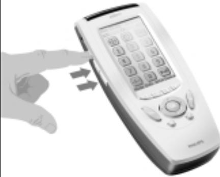
Para ajustar el contraste LCD en la pantalla táctil.
